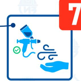
Подавайте воздух к пневмоинструменту только после установки его в рабочее положение
