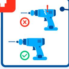
Следите за тем, чтобы рабочая часть пневмоинструмента не имела повреждений, трещин, выбоин и заусенцев
