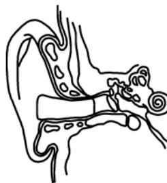
Рисунок F.4 – Правильная установка противошумного вкладыша
